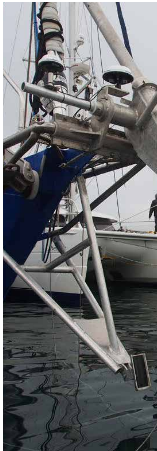
Muntita precizdistingiva plurradia sonaro sur la sveda ŝipo Explorer dum la VEGA-Ekspedicio 2013 al Gronlando.
